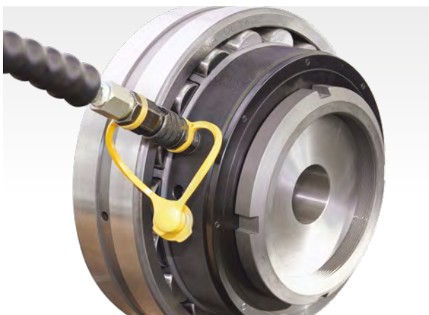
Extração da bucha de fixação com porca hidráulica
